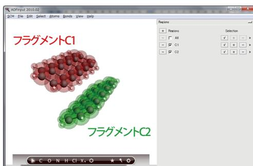
図3: ADF-GUIによるペンタセン2量体(T型)のフラグメントの設定
